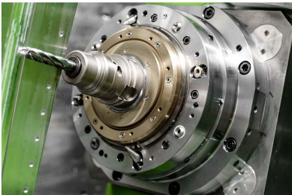
Bild 4: Um tiefe Taschen und filigrane Strukturen in einem Zug zu schlichten, setzt Zimmermann auf den VHM-Fräser SPM-Finish.
