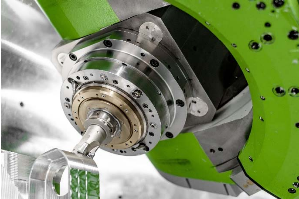
Bild 1: Das Horizontal-Bearbeitungszentrum, der 3-Achs-Fräskopf und der ISO-Eckfräser SPM-Rough erreichen im Zusammenspiel beste Ergebnisse.
