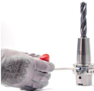
Der Wechsel bei einem Hydrodehnspannfutter dauert lediglich rund zwei Minuten.
