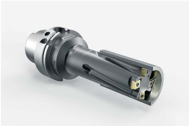
Bild 1: Für Aufbohrarbeiten mit großen Tiefen oder unter labilen Bearbeitungsbedingungen hat MAPAL Werkzeuge mit Wendeschneidplatten entwickelt. Letztere sind mit Bogenschliff versehen.
