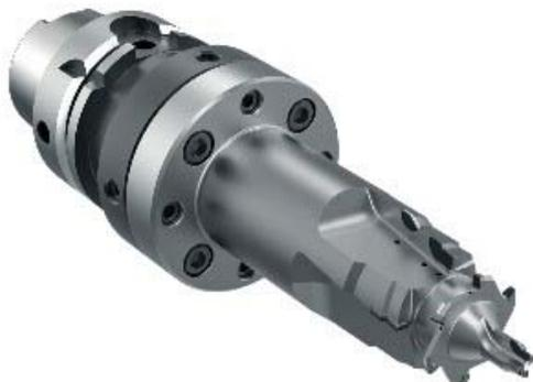
Das Werkzeug kombiniert die Fräs- und Bohrbearbeitung. Während Bohrstufen die Lagerbohrung und die Positionsbohrung bearbeiten, kommt eine Frässtufe zum Fertigen der Dichtnut zum Einsatz.
